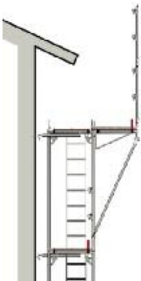
Sección con doble ancho de andamiaje y rejilla de protección.
