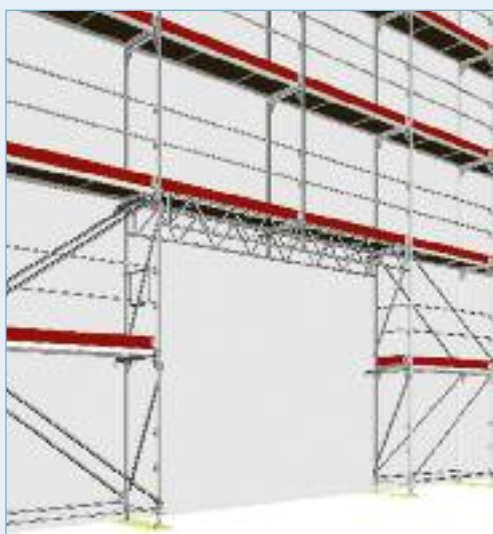
Ejemplo: Viga de celosía Blitz de 5,14 m. y andamio revestido (diagonalización especial).
